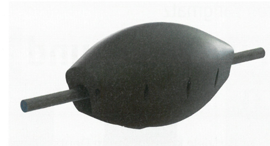
Bild 2. Direkt auf dem Leiterseil mit Seilklemmen befestigte autarke Sensorknoten erfassen die Parameter Neigung des Seils, Torsion des Seils und Stromstärke.
